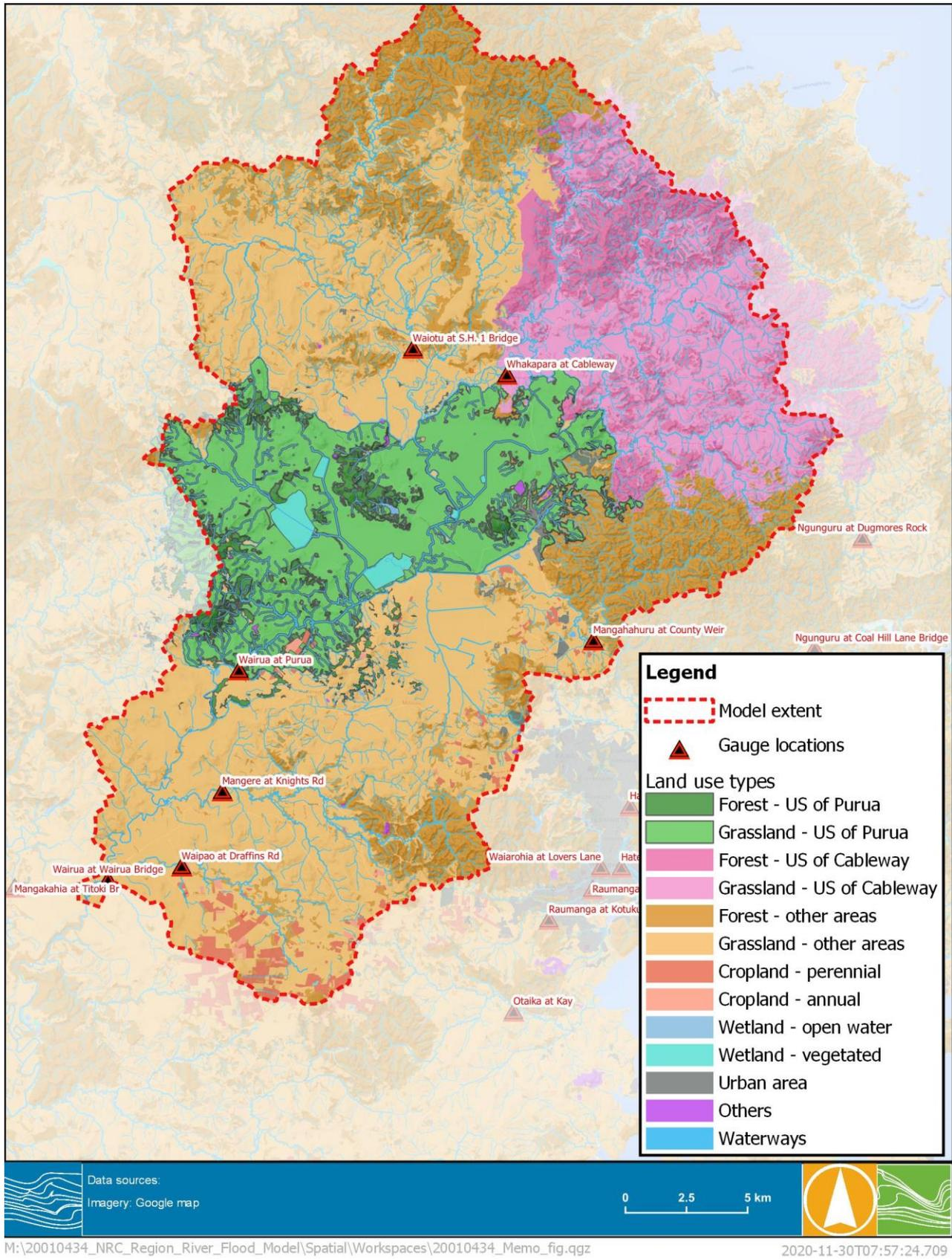
**FIGURE 8-4 HYDRAULIC MODEL MATERIAL LAYER – M14**
