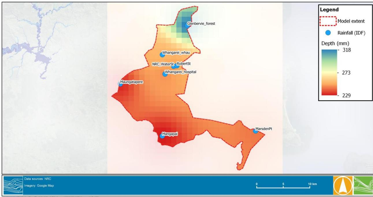
**FIGURE 4-1 EXAMPLE OF DESIGN RAINFALL GRID (12-HOUR, 1% AEP RAINFALL) FOR M01**
