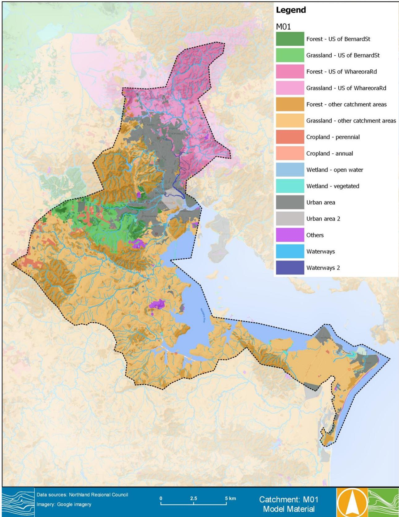
**FIGURE 4-3 HYDRAULIC MODEL MATERIAL LAYER**
