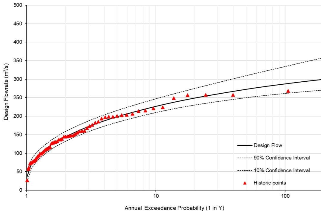
**FIGURE 6-2 EXAMPLE OF FLOOD FREQUENCY CURVE OF LOG PEARSON III DISTRIBUTION FIT**
